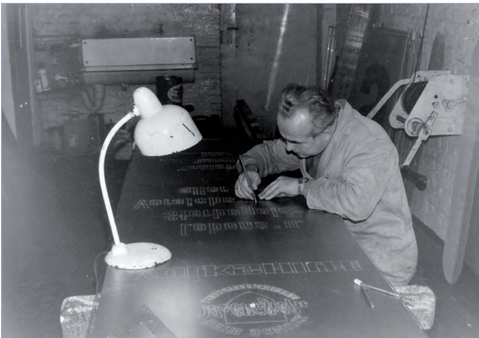
Hinterglasbeschriftung mithilfe von Bleifolie in den 1960er-Jahren © Klaus Bohlmann
